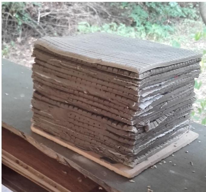
Rys. 5. Suszenie płytek przed wypałem na biskwit [zdjęcie K. Grygorowicz-Kosakowska]
