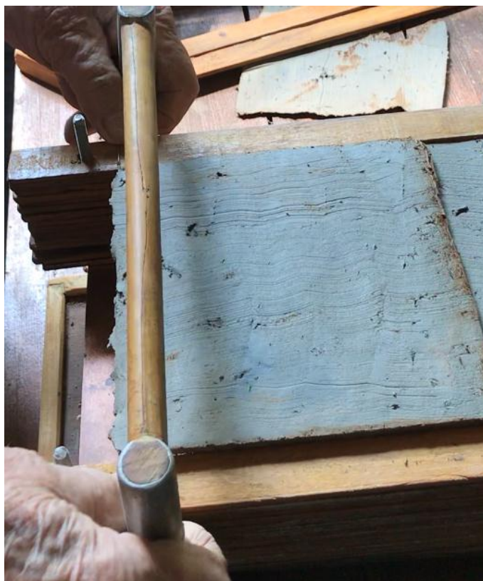
Rys. 3. Wycinanie kwadratowych plastrów nożem strunowym z bryły gliny [zdjęcie K. Grygorowicz-Kosakowska]
