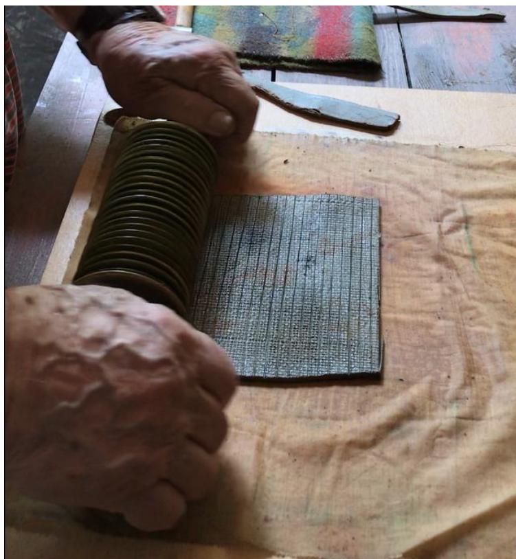
Rys. 4. Nacinanie płytek, by po wypale i szkliwieniu z łatwością można było pozyskiwać elementy do układania mozaiki [zdjęcie K. Grygorowicz-Kosakowska]
