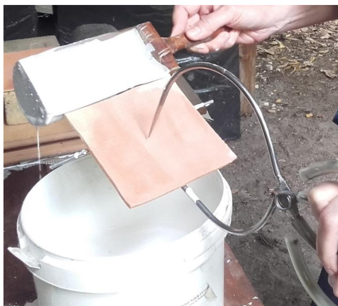
Rys. 6. Szklwienie nienaciętej strony, wypalanej na biskwit płytki [zdjęcie K. Grygorowicz-Kosakowska]
